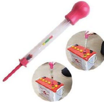
الشكل (٢٤) الهيدروميتر جهاز قياس كثافة المحلول.
