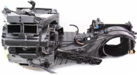
المحركات الكهربائية التي تتحكم في بوابات توجيه الهواء.
