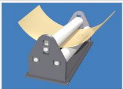
رسم ثلاثي الأبعاد لعملية درفلة شكل مخروطي
