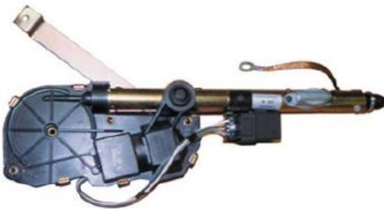
شكل (84): محرك كهربائي لهوائي ذي محرك كهربائي
